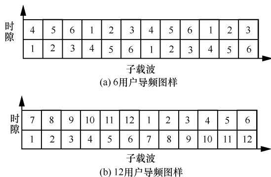
图4 RE-Sparse SCMA FDM 导频图样设计
